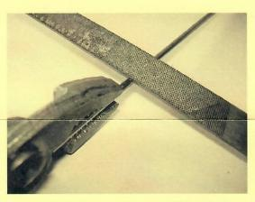
プライヤー等で、エレメントをしっかりと固定してから切断作業をしてください。切断後は切断部のバリをヤスリで除去してください。
